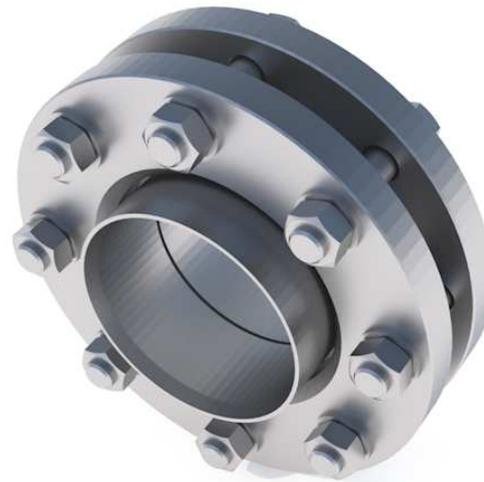
Aluminiumflansche Typ 02 (deutscher oder schwedischer Typ) können mit Manschettentyp 35 und 37 (EN 1092-1) verwendet werden. Gummi und weiches PTFE sind geeignete Dichtungsmaterialien. Das Flanschmaterial ist EN 1706 AC-47000-K-F.
